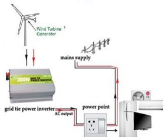
Figura 24 - Conexão do conjunto aerogerador / inversor à rede local. Fonte: Hummer
